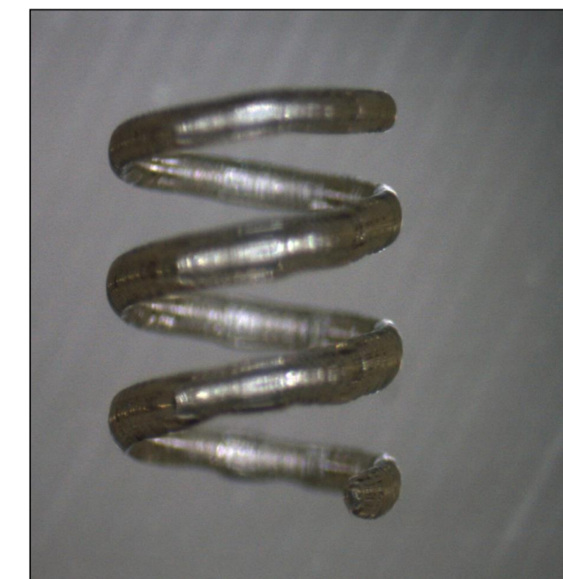
PMMA内部の流路加工
