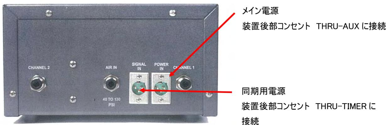
7) 操作 BOX 後部の 100V コンセントに、攪拌装置 (AS-2) を接続して下さい。
