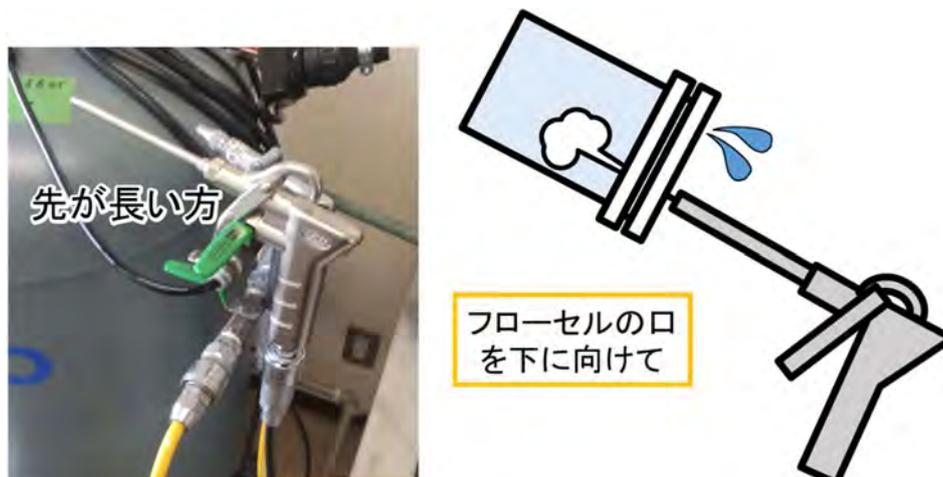
5. 2~4の操作を繰り返し、フローセルを粒度分布計のフローセルホルダに戻す.
