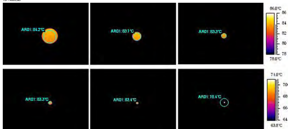
図 28.20 距離を遠ざけながら +85°C 黒体から読み取った温度 (24 レンズ)
