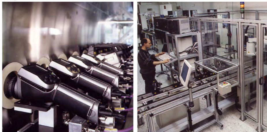
図 29.5 左: 気候室での赤外線カメラの試験。右: カメラテストおよびキャリブレーション用ロボット
