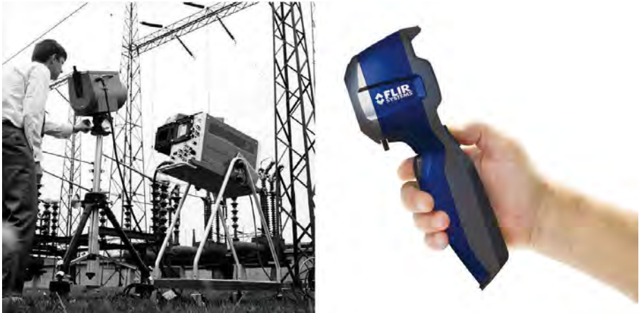
図 29.2 左Thermovision® Model 661、1969年発売カメラの重量は約25 kg (55 lb.)、オシロスコープは20 kg (44 lb.)、三脚は15 kg (33 lb.)です。オペレータは220 VACジェネレーターセットと、液体窒素の入った10 L (2.6 USガロン) 容器も必要です。オシロスコープの左側には、ポラロイドのタッチメント (6 kg/13 lb.)があります。右: FLIR i7、2009年発売重量:0.34 kg (0.75 lb.)、バッテリーを含む
