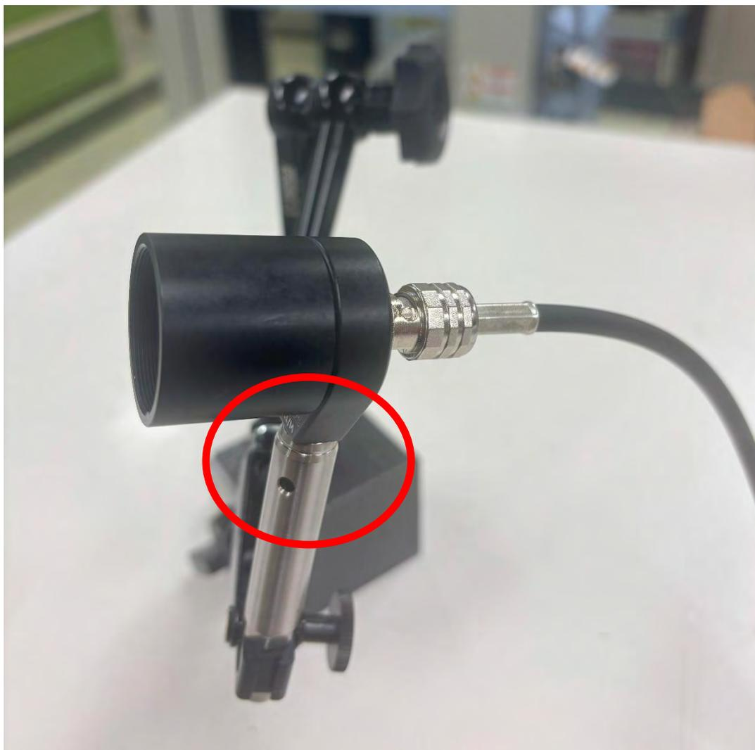
④ フォトセンサアンプの電源を ON にする（レバーを少し引きながら持ち上げる）
